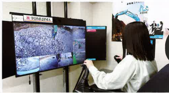
本社オフィス内の超遠隔操作システム。現場の音声、傾きや遠隔操作に影響する微細な振動をモーションシートにフィードバックできる。急勾配や岩が多い現場でも重機に搭乗し操作しているかのようなリアルな感覚が得られるので、何100km離れた本社からでも安全かつスムーズな重機操作が可能となる(大阪から秋田の現場など)。
